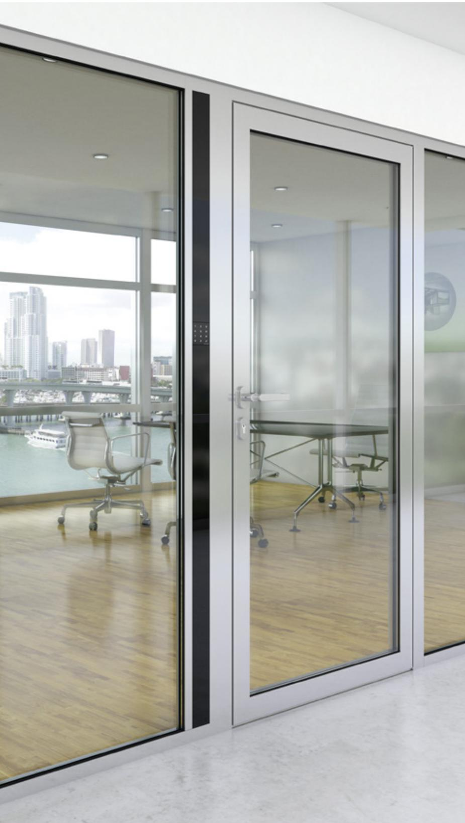
Das Schüco DCS ist in der Fluchttürsicherung, Zutrittskontrolle und Türkommunikation einsetzbar. Es können bis zu drei Module pro Seite eingesetzt werden. Das System ist brand-schutztechnisch geprüft nach EN 1364/1634 sowie nach DIN 4102. Für den Einsatz im Rauchschutzsystem Schüco ADS 65.NI SP ist es geprüft nach EN 1634/3 und DIN 18095.
