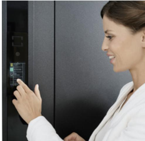
Nähert sich eine Person der Haustür, wechselt das Display mithilfe des integrierten Sensors von der Hausnummer zum Klingelschild (im Einfamilienhaus) bzw. zur alphabetischen Klingelliste, die sich – wie beim Smartphone – durch Scrollen mit dem Finger bedienen lässt.
